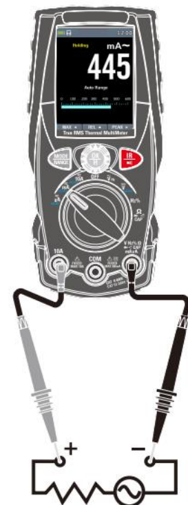
Abbildung 17: Positionierung der Messspitzen für Strommessungen
